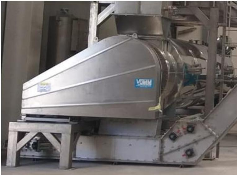
I rifiuti ospedalieri triturati in continuo vengono raccolti, trasportati e dosati da una coclea nel TURBO STERILIZZATORE.
