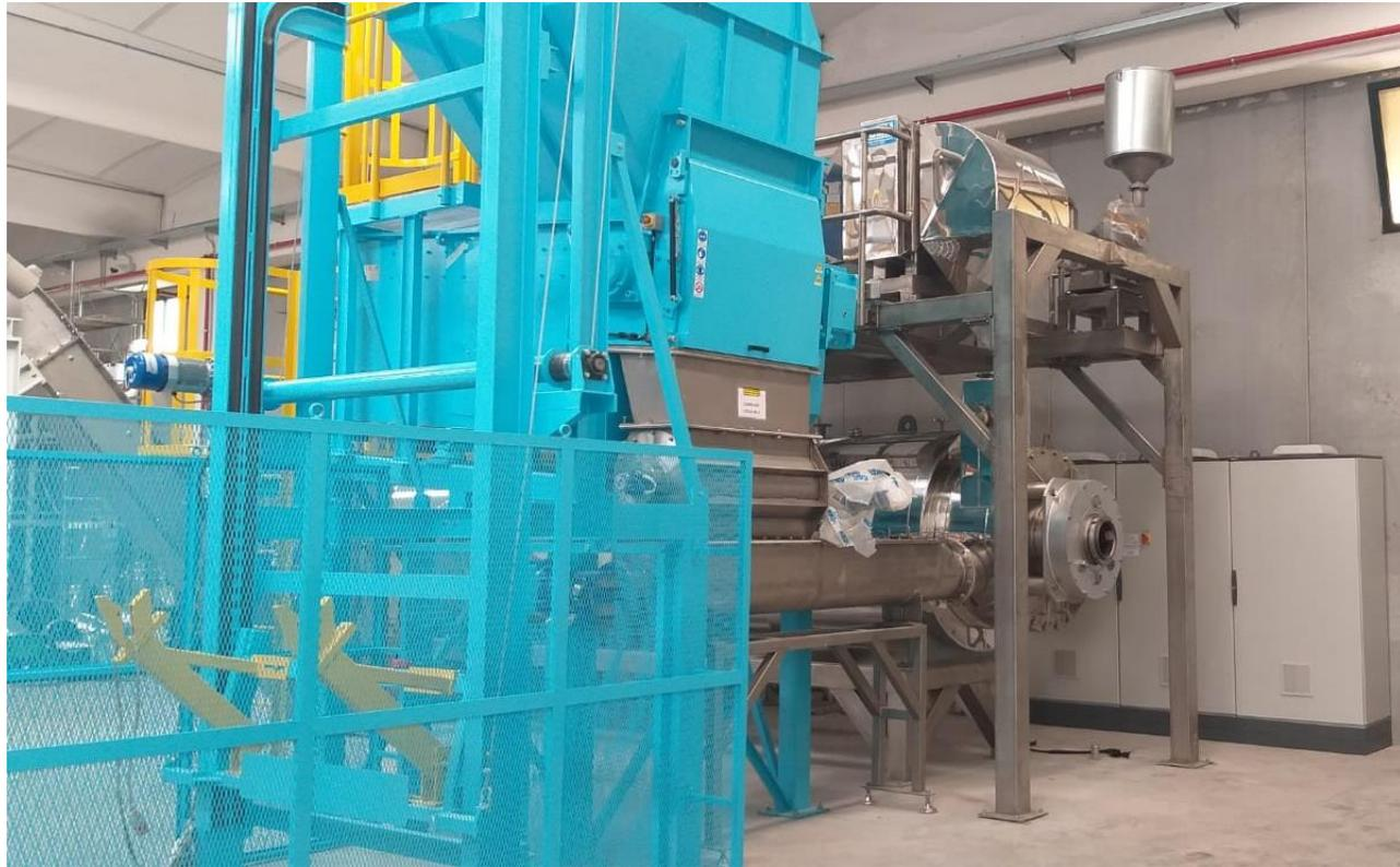
Nella parte inferiore della tramoggia di carico si trova il trituratore continuo a lame rotanti, che riduce contenitori e rifiuti ad una pezzatura omogenea, secondo le specifiche del Cliente.
